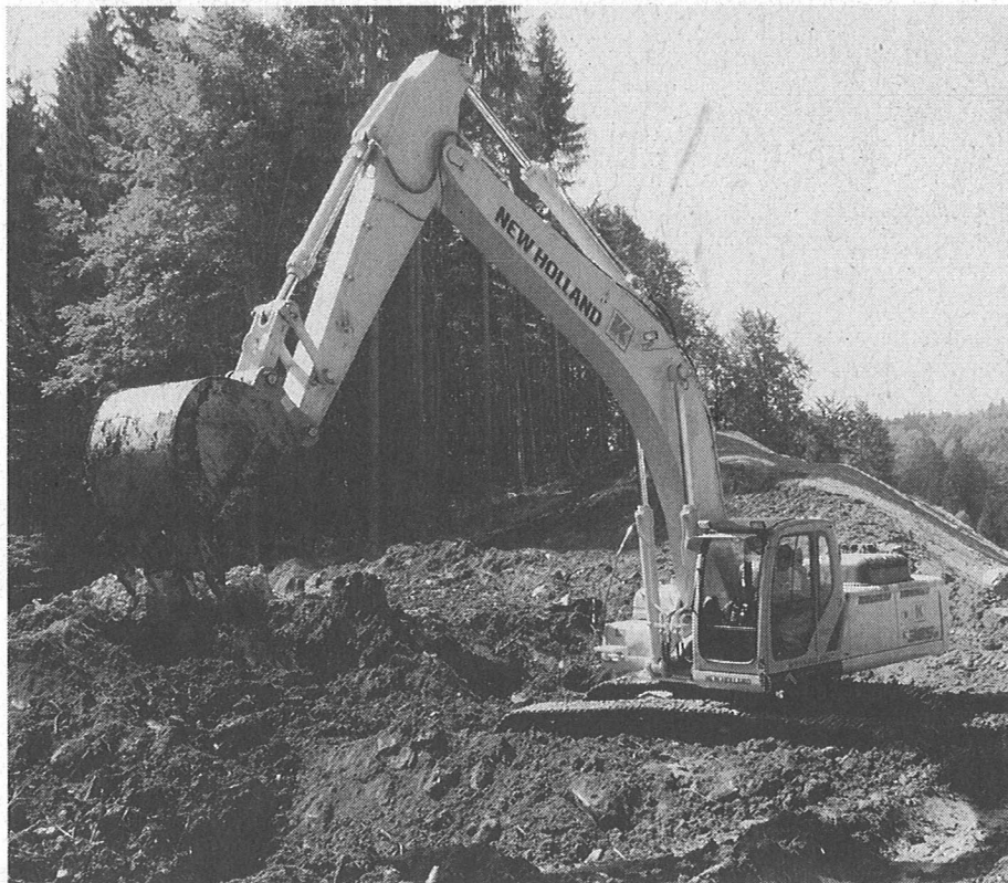
Der Raupenbagger E 385 arbeitet kraftvoll und kostengünstig auch bei schweren Einsätzen. Sein „Continuous Power Boost“ verleiht ihm zusätzliche Hydraulikkraft. Foto: New Holland
